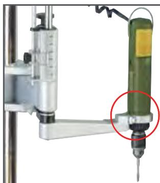
Скорость 250 об/мин и практичный кулисный переключатель прямое вращение / выкл. / обратное вращение электроотвертки MIS 1 удобны для нарезания резьбы. Метчик надежно закреплен и обеспечивает четкую вертикаль при нарезании внутренней резьбы.
