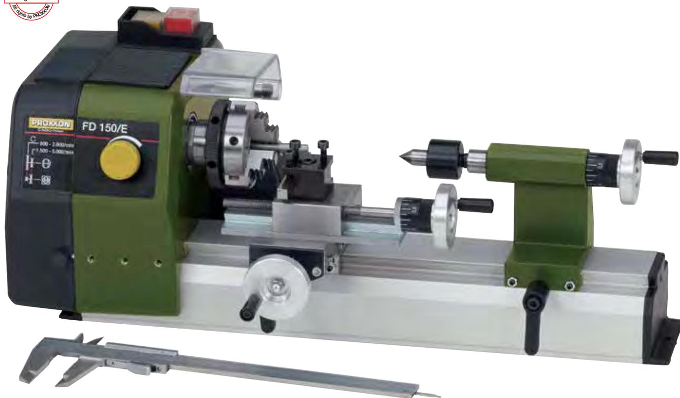
**Межосевое расстояние 150 мм. Высота центров над направляющими 55 мм. Высота над суппортом 33 мм.**
