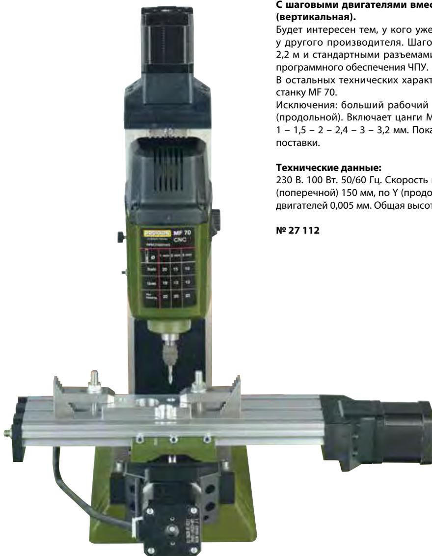
**С шаговыми двигателями вместо маховиков по осям X (поперечная), Y (продольная) и Z (вертикальная).**
