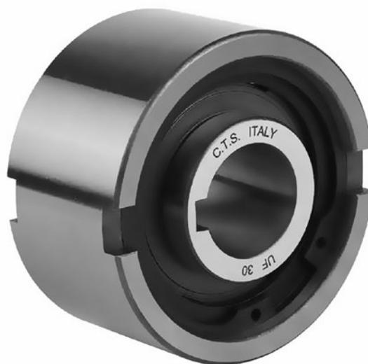
Обгонные муфты серии UF самоцентрирующиеся. По этой причине, совместно с обгонной муфтой, необходимо устанавливать один или два подшипника, чтобы обеспечить соосность внутреннего и наружного колец муфты.
