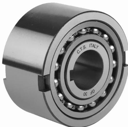
Обгонные муфты серии GF являются самоцентрирующимися. Для размеров от 8 до 20 центрирование происходит «сталь по стали», в то время как для размеров от 25 до 130 – посредством двух встроенных шарикоподшипников 160 серии.
