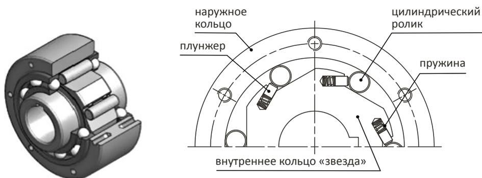
рис.1 Муфта с цилиндрическими роликами
