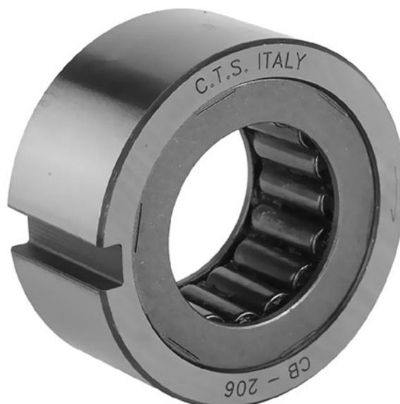
Обгонные муфты серии СВ-200 с ассиметричными роликами являются несамодцентрирующимися. Поэтому необходимо устанавливать один или два подшипника рядом с обгонной муфтой, чтобы обеспечить центровку наружного и внутреннего колец при вращении.
