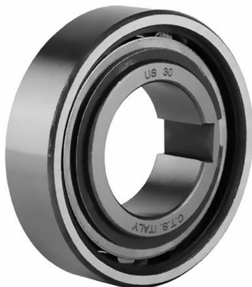
Обгонные муфты серии US несамоцентрирующиеся. По этой причине, совместно с обгонной муфтой, необходимо устанавливать один или два подшипника, чтобы обеспечить соосность внутреннего и наружного колец муфты.
