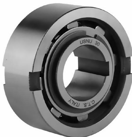
Обгонные муфты серии USNU несоосноцентрирующиеся. По этой причине, совместно с обгонной муфтой, необходимо устанавливать один или два подшипника, чтобы обеспечить соосность внутреннего и наружного колец муфты.
