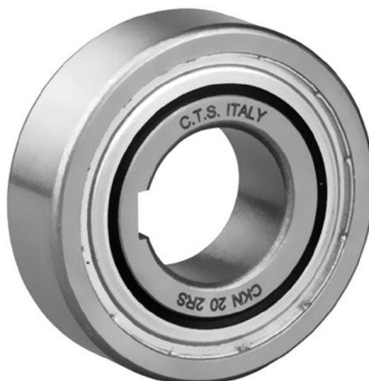
Обгонные муфты серии СКН соответствуют по размерам подшипникам 62 серии. Это самоцентрирующиеся обгонные муфты, смазанные на весь срок службы и снабжены водонепроницаемыми уплотнениями.
