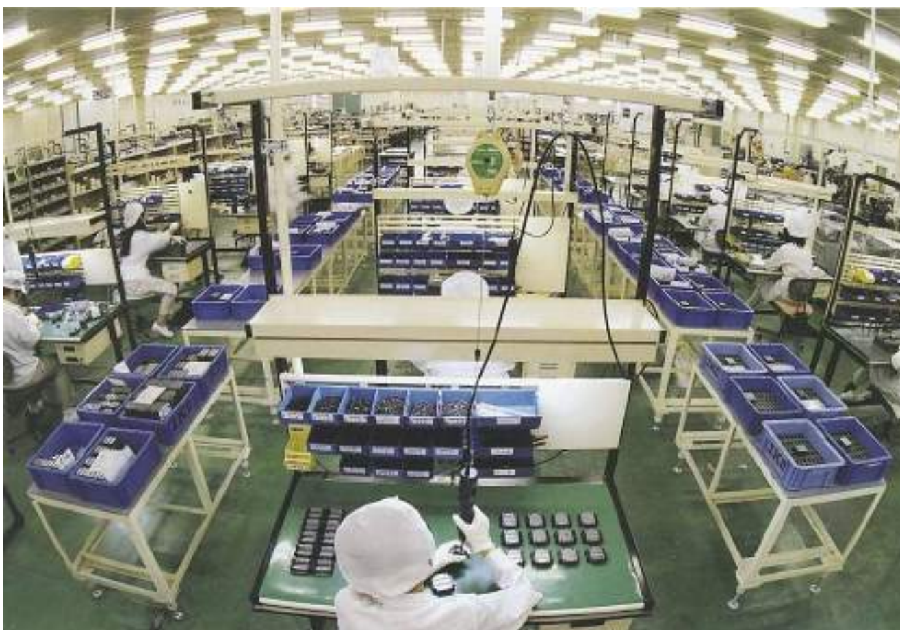
Процесс сборки в чистой комнате
