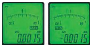
Измерение макс./мин. значения или биения (амплитуды)
