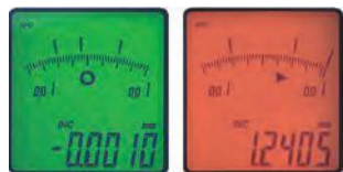
Дисплей переключается с зеленого на красный, если превышен верхний или нижний допуск
