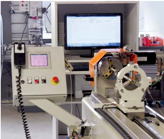
CONTRÔLE COUPLE DE ROTATION Vis à billes et écrous à billes Selon la norme ISO 3408-3
