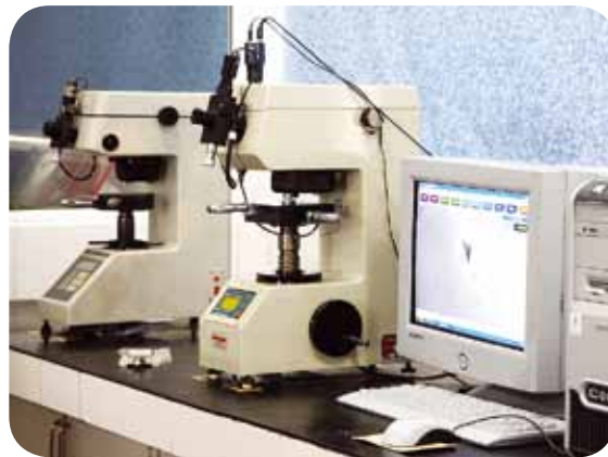
Прибор измерения микротвердости для серийного контроля соответствия твердости требованиям SKF
