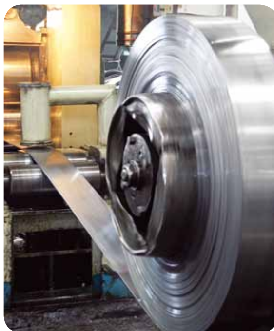
Машина для холодного проката, обеспечивающая точность толщины материала
