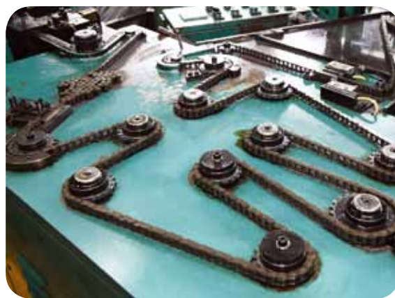
Автоматизированная линия по сборке цепей, гарантирует соблюдение необходимых допусков и посадок
