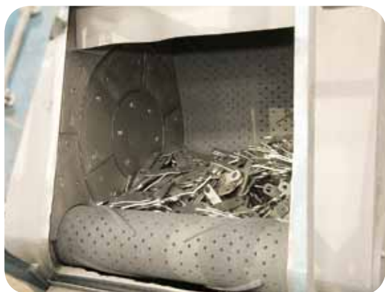
Дробеструйная обработка деталей увеличивает усталостную прочность
