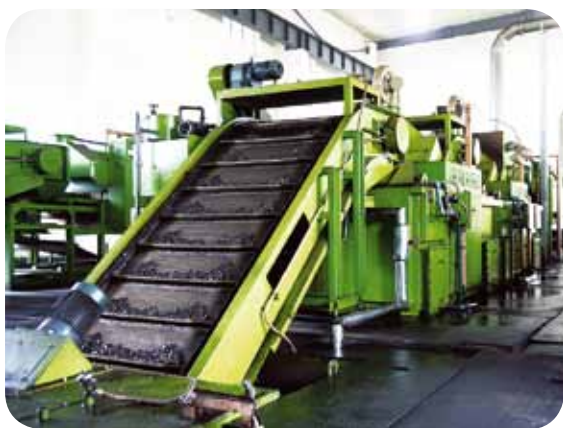
Конвейерные печи, применяемые для термического упрочнения роликов и втулок (цементация и азотирование)
