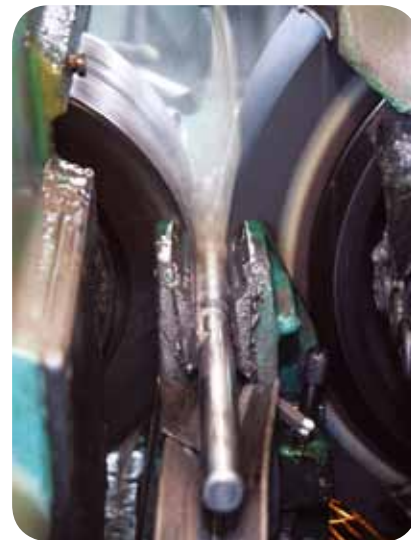
Прецизионное шлифование штифтов для повышения износостойкости и увеличения срока службы цепи SKF
