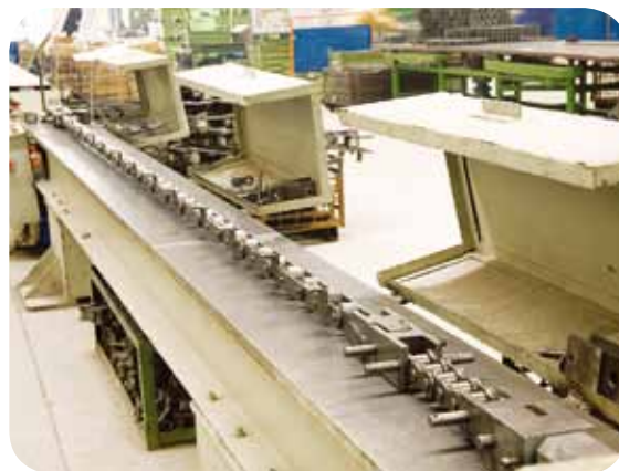
Преднатяжение цепи после окончательной сборки
