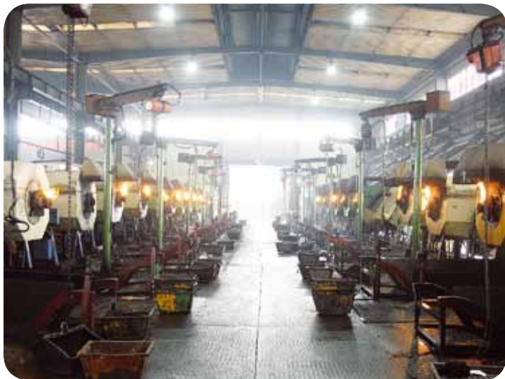
Печи для термообработки вращающихся заготовок обеспечивают очень равномерное распределение тепла
