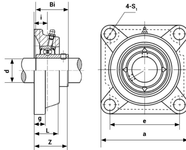
Узлы серии UKF имеют квадратную форму фланца. Крепятся с помощью зажимной втулки. Опорная поверхность идёт строго перпендикулярно оси вращения самого подшипника. Отличаются малозумностью. Предназначены для работы при больших скоростях вращения с необходимостью обратного хода.
