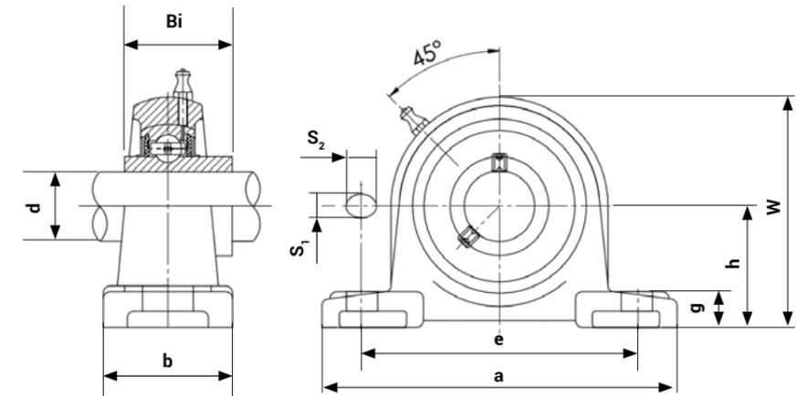
Выдерживают высокие радиальные нагрузки и крепятся на вал с помощью зажимной втулки.
