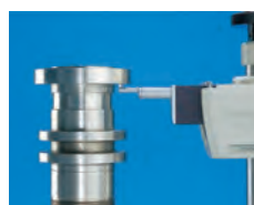
Измерение в перевернутом положении
