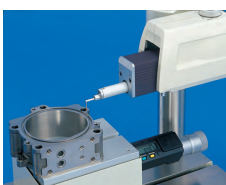
Измерение глубоких канавок
