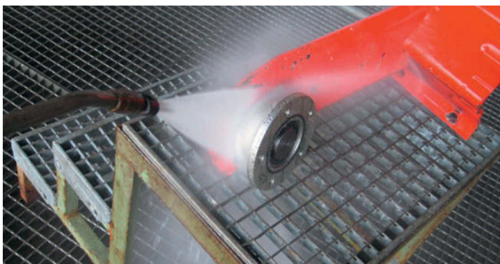
Рисунок 3: Испытание подшипникового узла посредством мытья под давлением на протяжении 200 часов. В конце испытания не было обнаружено никаких признаков попадания воды внутрь кассетного уплотнения.
