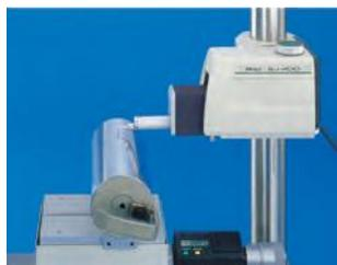
Измерение радиусной поверхности
