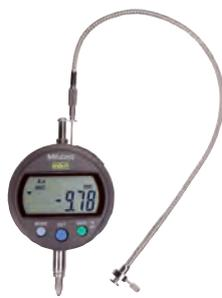
Кабель подъёма стержня 300 мм
