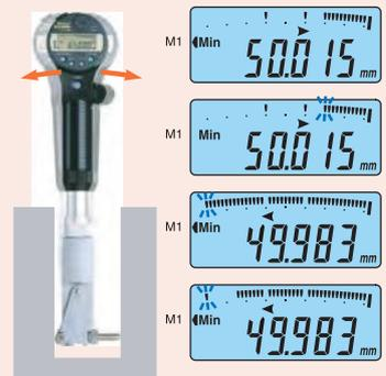
Индикаторный нутромер ABSOLUTE Digimatic определяет минимальное значение (истинный диаметр) и автоматически сохраняет его.
