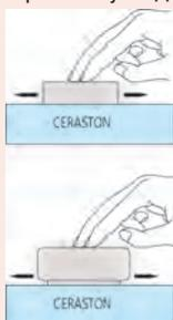
**Заметка:** Абразивная поверхность Ceraston должна быть плоской посредством полировки время от времени. После полировки Ceraston, порошок должен быть полностью удален с поверхности камня, чтобы предотвратить царапины на КМД. Митутойо не предлагает Арканзасские камни.
