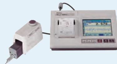
Приборы для измерения контура
