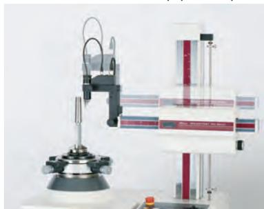
Измерение в процессе слежения по оси X
