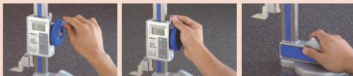
Регулировочное колесико    Стопорный рычаг ползунка    Эргономичная опора
