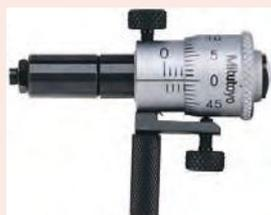
При использовании одного удлинительного стержня
