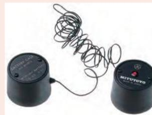
Электрический контактный датчик
