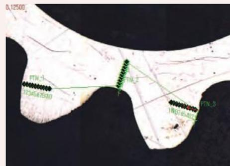
Графический вид (сохраненных изображений) для отображения вида образца и наложения шаблонов. Функцию цифрового зума можно использовать для простоты увеличения отпечатка.
