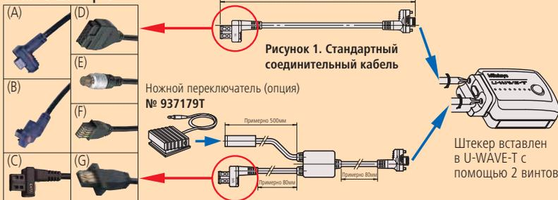
Рисунок 2. Кабель для подключения ножного переключателя
