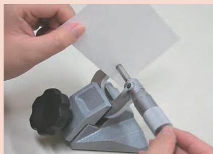
5. Ежедневно стирайте пыль, стружку и другие загрязнения с периферийной и измерительной поверхностей микрометрического винта (шпинделя). Кроме того, необходимо стирать сухой тканью пятна и отпечатки пальцев со всех частей инструмента.
