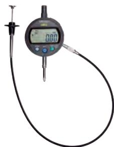
Кабель подъёма стержня 500 мм
