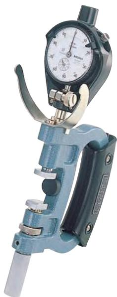
201-101 с дополнительным индикатором часового типа
