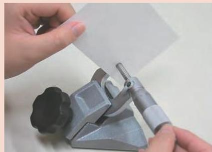
5. Ежедневно стирайте пыль, стружку и другие загрязнения с периферийной и измерительной поверхностей микрометрического винта (шпинделя). Кроме того, необходимо стирать сухой тканью пятна и отпечатки пальцев со всех частей инструмента.
