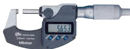
293-234-30 с трещоточным барабаном
