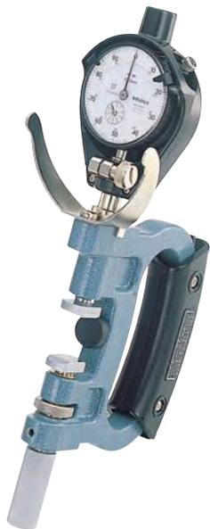
201-101 с дополнительным индикатором часового типа
