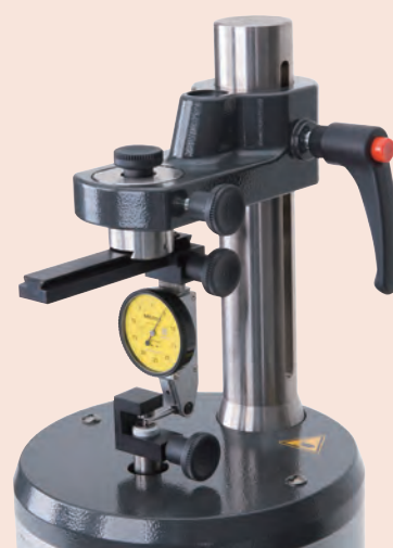
Калибровка рычажно-зубчатых индикаторов с дополнительными принадлежностями
