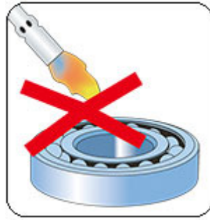
Подшипник нельзя нагревать с помощью открытого огня
