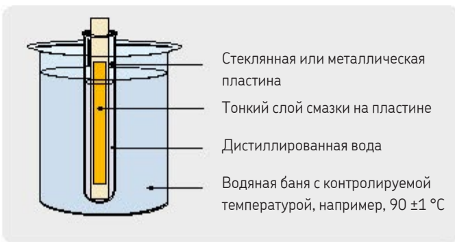
Испытание на водостойкость
