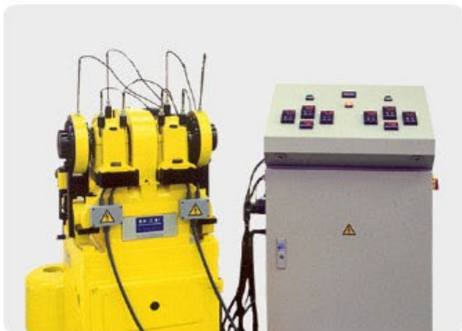
Машина R2F для испытания пластичной смазки
