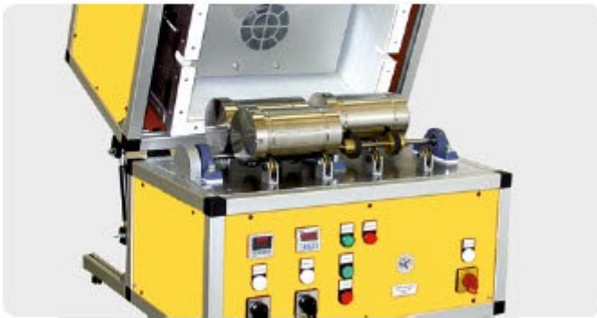
Машина для испытания стабильности при перекачивании
