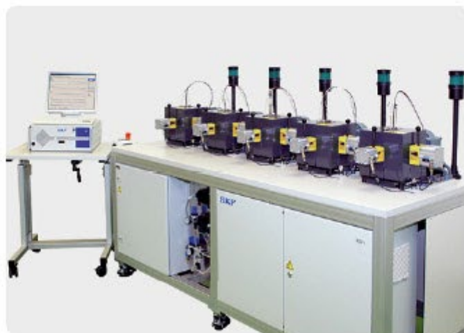
Машина ROF+ для испытания пластичной смазки
