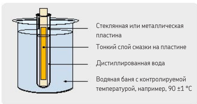
Испытание на водостойкость
