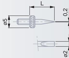
Стальные измерительные вставки с изм. поверхностью в форме лезвия. Контргайка для радиального выравнивания.
