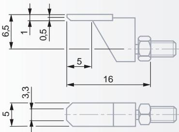
Измерительная вставка с узкой, эксцентричной измерительной поверхностью. Контргайка для радиального выравнивания.
