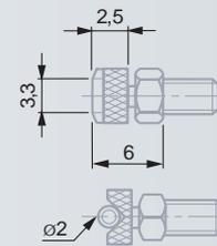
Измерительные вставки с цилиндрической изм. поверхностью. Контргайка для радиального выравнивания.
