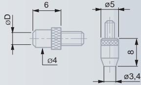
Измерительная вставка с плоской измерительной поверхностью
