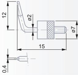
Измерительная вставка со смещенной (А) точечной изм. поверхностью, контргайкой для радиального выравнивания
