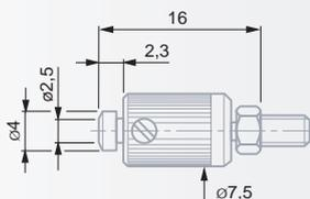
Измерительная вставка с плоской измерительной поверхностью, с регулировкой параллельности. Контргайка для радиального выравнивания.
