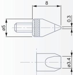
Измерительные вставки с изм. поверхностью в форме лезвия. Контргайка для радиального выравнивания.
