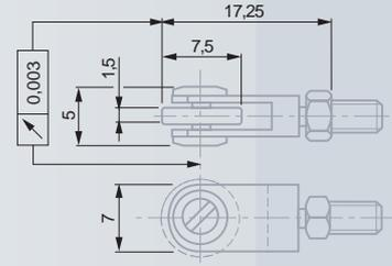
Измерительные вставки с роликом на шариковой опоре
