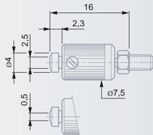
Измерительная вставка с узкой, эксцентричной измерительной поверхностью, с регулировкой параллельности. Контргайка для радиального выравнивания.
