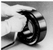
Рис. 1. Проверка зазора подшипника на верстаке.
