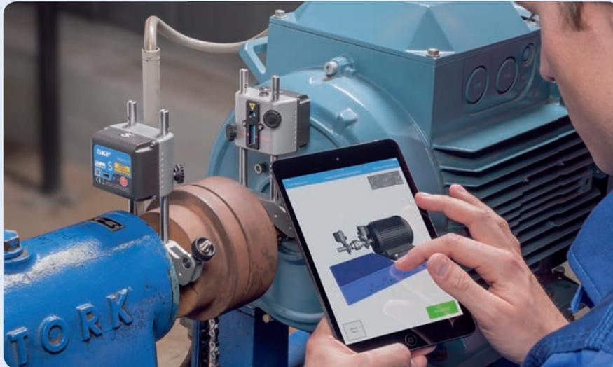
Прибор для выверки соосности валов TKSA 51 имеет самый широкий диапазон применения среди инструментов серии TKSA. Компактная и лёгкая конструкция, широкие измерительные возможности и входящие в комплект принадлежности позволяют использовать прибор практически на любом оборудовании, даже в труднодоступных местах. Защитные чехлы на планшетах и смартфонах не ухудшают рабочие характеристики TKSA 51.
