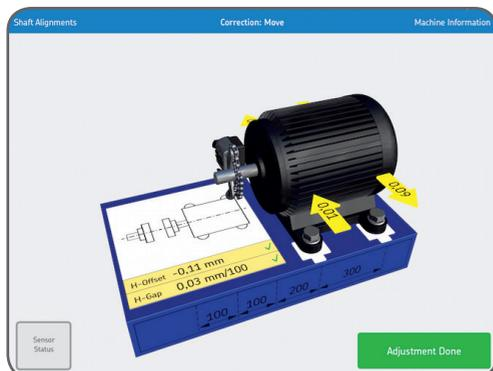
Анимация показывает затягивание болтов. Выверка завершена, для подтверждения результатов необходимо повторить измерение. Нажмите «Remeasure» (Повторное измерение).
