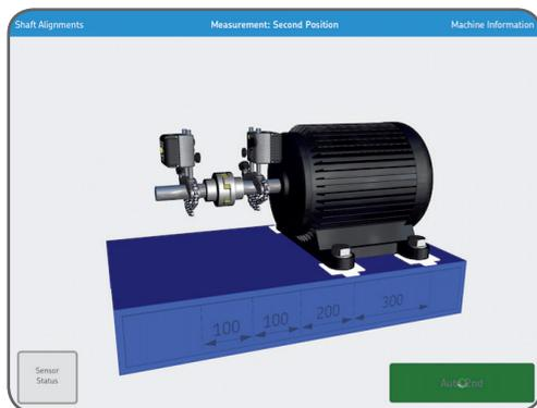
Когда система определяет достаточность прокручивания вала, который после этого оставался неподвижным в течение короткого времени, автоматически регистрируется 3<sup>е</sup> положение измерения.
