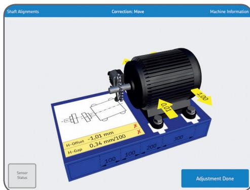
После коррекции, либо если коррекция не требуется, нажмите «Регулировка завершена» (Adjustment Done).
