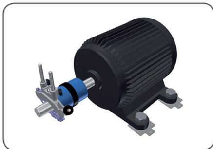
Для валов с диаметром до 40 мм (менее 1,5") зацепить цепь на анкере с внутренней стороны. Для валов большего диаметра зацепить цепь с наружной стороны. Выбрать слабину цепи и надежно затянуть цепь с помощью ручки натяжителя.
