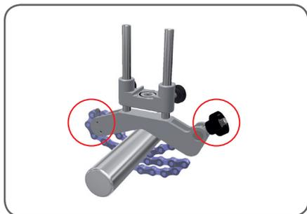
Установить другой кронштейн на валу "подвижной" машины. Как правило, это приводная машина, например, электродвигатель. Следует стремиться устанавливать кронштейны на небольшом расстоянии друг от друга.
