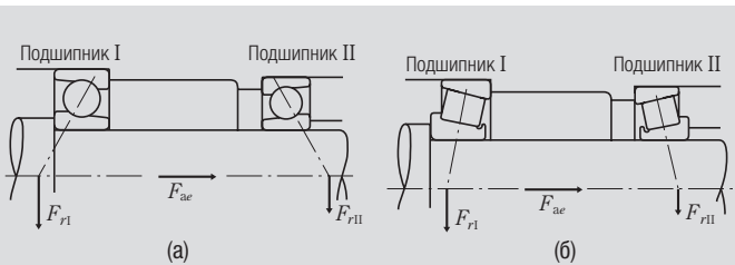
Рисунок 5.12. Нагрузки на подшипники, установленные парой напротив друг друга
