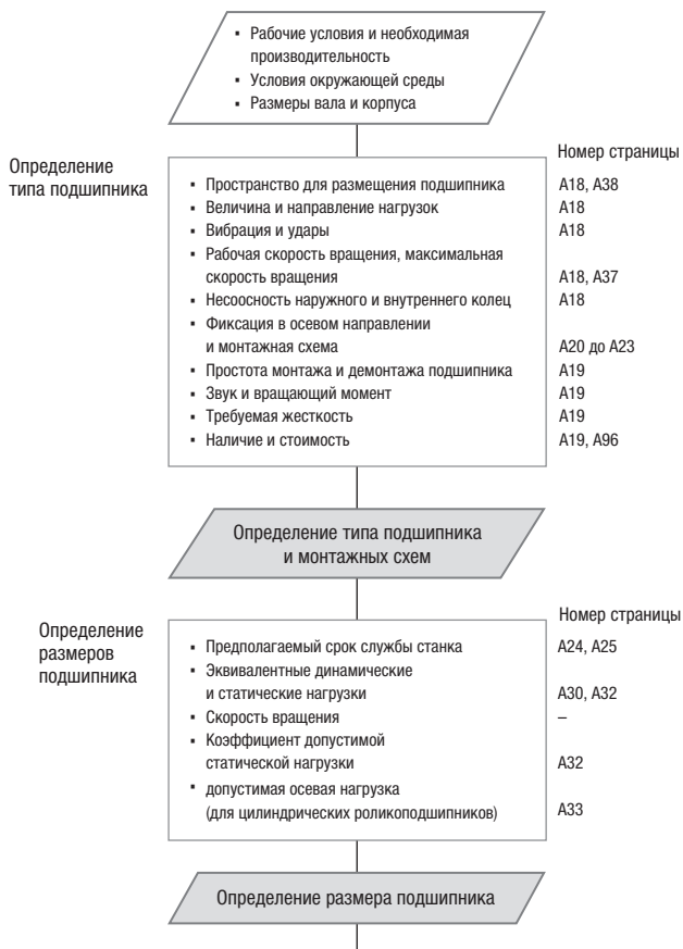
Рисунок 2.1. Схема подбора подшипников качения
