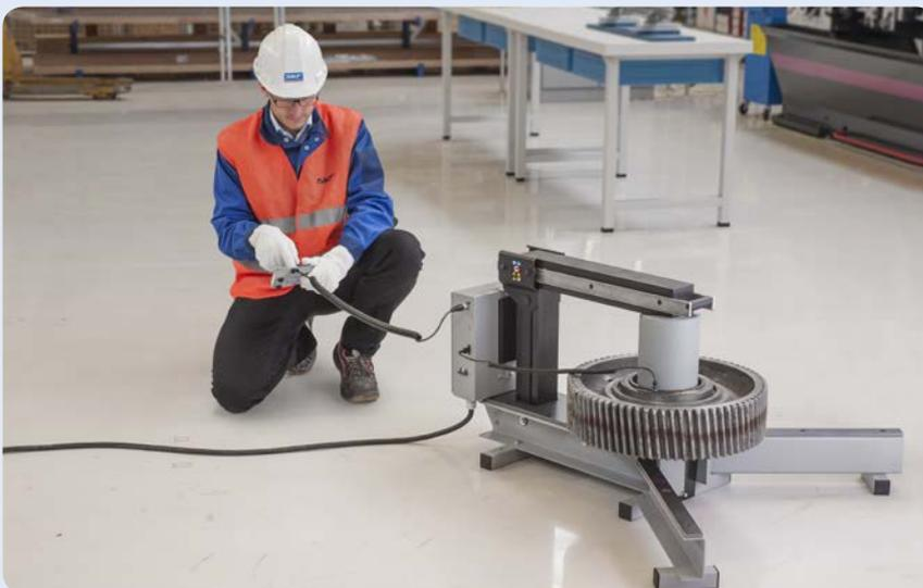
В целях безопасности индукционный нагреватель серии TИH L MB оснащается панелью дистанционного управления.
