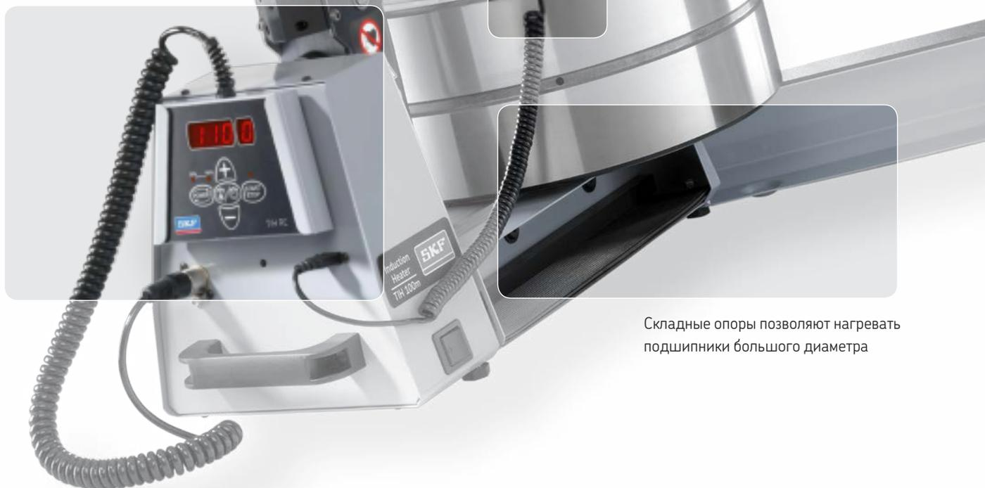
Складные опоры позволяют нагревать подшипники большого диаметра
