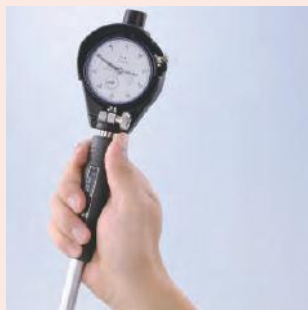
Большая теплоизоляционная ручка
