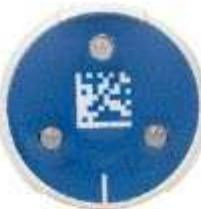
На верхней панели устройства расположены три индикатора для отображения состояния оборудования и подшипников. Кроме того, имеется штрих-код с серийным номером для идентификации оборудования в рамках программы «Обеспечение надёжности оператором» (ODR), графика техобслуживания или плановых проверок. Основание из нержавеющей стали в нижней части устройства оснащено резьбой 1/4–28 для монтажа на штифтах.
