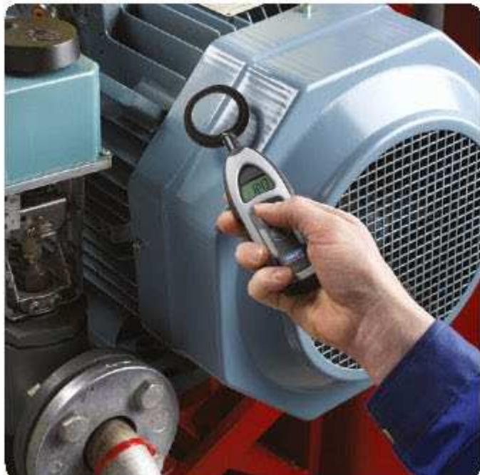
Наиболее подвержены электрической эрозии подшипники в электродвигателях, управляемых с помощью частотных преобразователей. При использовании в рамках программы техобслуживания по фактическому состоянию детектор EDD Pen может помочь определить подшипники, которые с большей вероятностью выйдут из строя, и предотвратить незапланированные простои оборудования.
