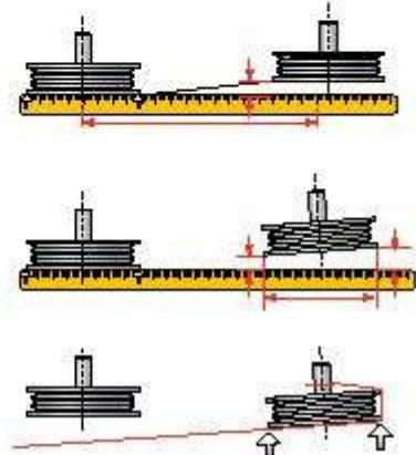
Измерение параллельного и углового перекоса с использованием поверочной линейки или натянутой струны
