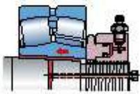
Гидравлическая гайка серии HMV ..E используется для монтажа подшипника на коническую шейку вала.
