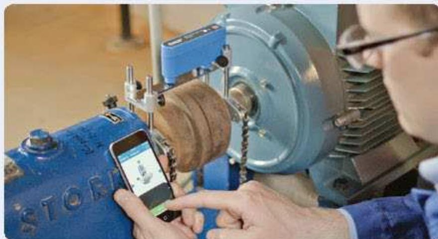
Выверка соосности валов значительно повышает эксплуатационную готовность оборудования и снижает расходы на техобслуживание, поэтому рекомендуется практически в любой отрасли. TKSA 11 в основном предназначен для тех отраслей, где данные преимущества выверки соосности валов еще не реализованы, и где прибор может помочь клиентам увеличить прибыль благодаря правильной выверке соосности валов.
