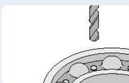
Удалить уплотнения (при наличии) и рассверлить сепаратор. Удалить образовавшуюся стружку.
