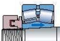
1. Определите, одна или две поверхности скольжения имеют место при монтаже (см. рис.).
