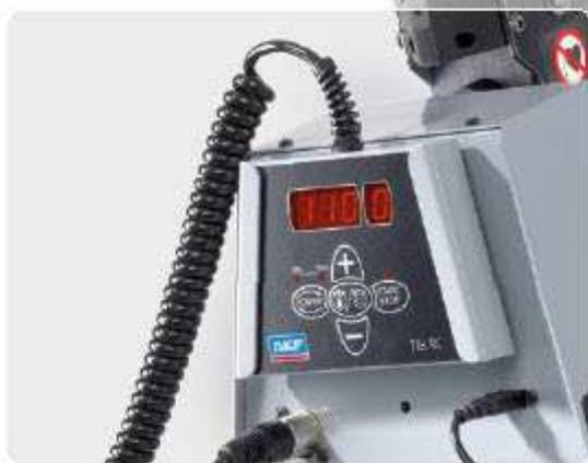
Магнитный датчик, устанавливаемый на внутреннее кольцо, позволяет контролировать температуру подшипника и предотвращать его перегрев
