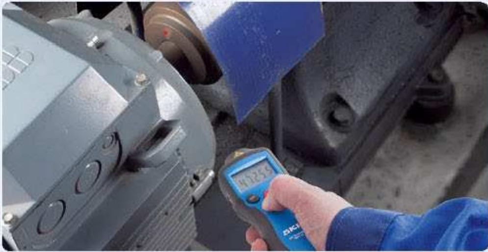
Оптическая лазерная система обеспечивает простое и быстрое измерение на безопасном расстоянии от узлов вращения.
