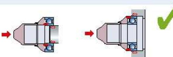
Использование соответствующих инструментов позволяет избежать повреждений дорожек качения
