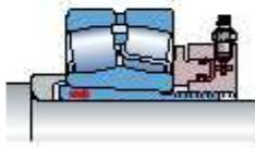
Гидравлическая гайка серии HMV ..E используется для монтажа подшипника на закрепительную втулку.
