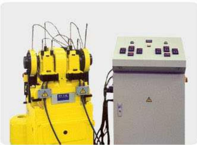
Машина R2F для испытания пластичной смазки
