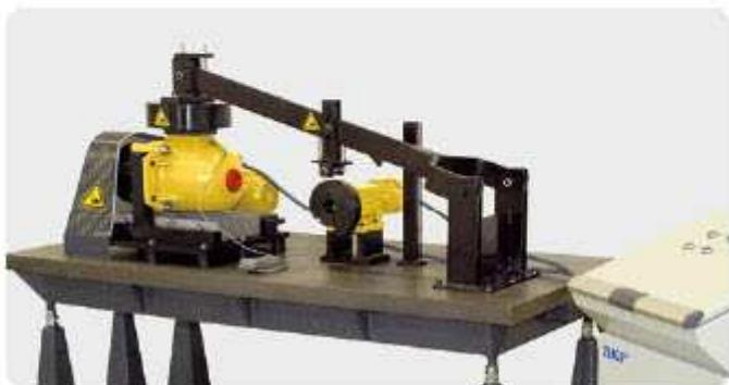
Машина V2F для испытания пластичной смазки
