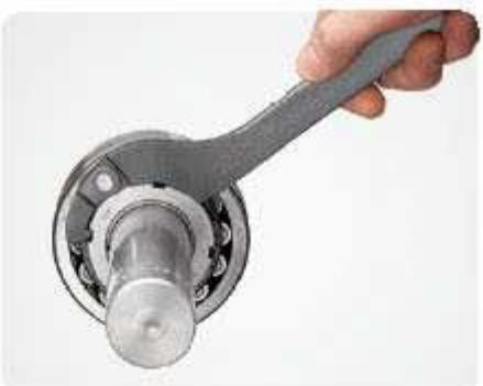
Четыре ключа позволяют затягивать гайки 24 размеров
