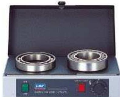
Температура нагрева подшипника регулируется терmostатом
