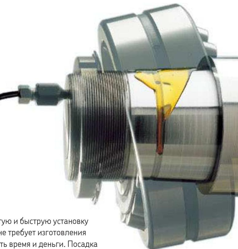
При демонтаже подшипников с конических посадочных мест при помощи метода гидрораспора SKF усилие натяга полностью преодолевается за счёт подачи масла под давлением. После этого подшипник легко снимается с посадочного места без использования съёмника. Необходимо использовать стопорную гайку для ограничения перемещения подшипника. Метод гидрораспора SKF, который используется для многих подшипников, также может применяться для демонтажа других деталей:
