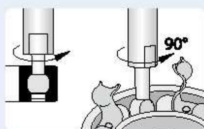
Ввести второй захват в подготовленной диаметрально противоположной области.
