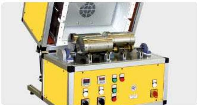
Машина для испытания стабильности при перекатывании
