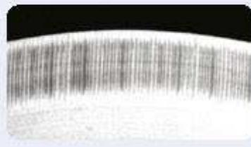
Канавки, характеризующие электрическую эрозию в подшипнике
