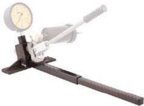
Адаптер SKF 226402 состоит из литого стального корпуса, к которому подключаются манометр и трубопровод высокого давления. Адаптер поставляется в комплекте с упором для фиксации на полу и угловым переходником для контейнера с маслом.
