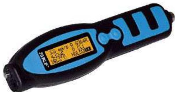
са, несоосностью и ослаблением крепления деталей, с запрограммированными в нём нормативными значениями, установленными Международной организацией по стандартизации (ISO). Если результаты измерений превышают эти нормативные значения, прибор выдаёт сигналы «Предупреждение» или «Опасность». Одновременно осуществляется измерение «огибающей виброускорения».
