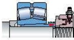
Гидравлическая гайка серии HMV ..E используется для монтажа подшипника на стяжную втулку.
