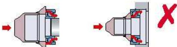
Неравномерное распределение усилия приводит к повреждению подшипника
