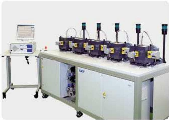
Машина ROF+ для испытания пластичной смазки
