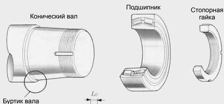
Примечание: Когда уменьшение зазора подшипника достигнет заданного значения, измерьте размер  $L_0$  в 8 точках, равномерно распределенных по окружности.
