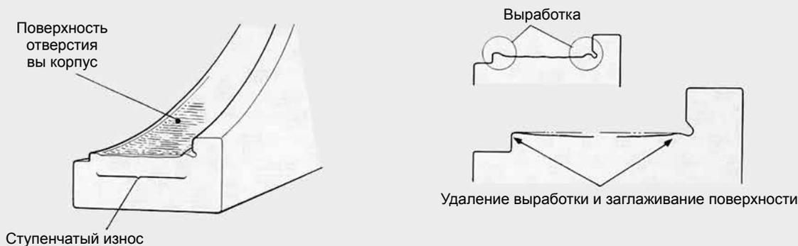
(2) Осмотр поверхности отверстия корпуса Осмотрите поверхность под посадку в корпусе на предмет наличия царапин, вмятин, ржавчины или ступенчатого износа.
