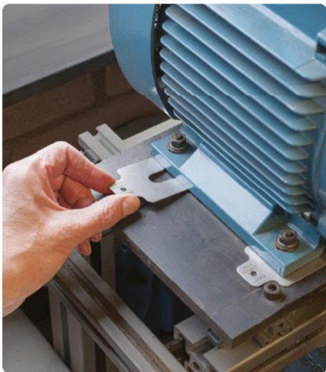
Предназначены для точной выверки механизмов в вертикальной плоскости
